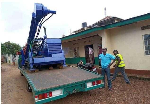
Bohrmaschine Ditch Witch 23 mit Spülpumpe, Bohrgestänge, Bohrmeißel und einem Abschlepp-LKW für den Transport der Bohrmaschine
